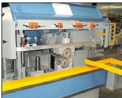
Toutes les commandes de la machine sont au front et sont à précision jusqu'à un dixième.
